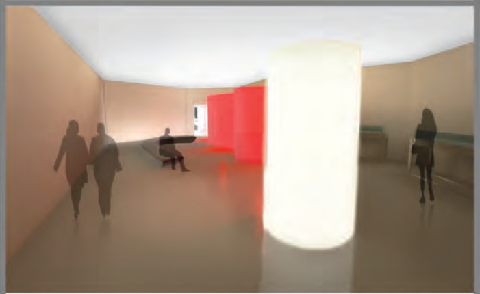
BARRYSOL Si smonta e si rimonta in tempo record, conservando inalterate nel tempo le sue qualità estetiche e funzionali. un soffitto teso in barriol è costituito da una lamina in PVC atossico testata da muro a muro, fabbricata su misura per la stanza e fissata con dei profili. E' stato utilizzato nel progetto per la controsoffittatura nella parte espositiva del museo, e nella parete divisoria sempre nella parte espositiva. Tale telo ha una facciata bianca e l'altra rossa.
